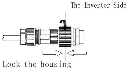
5. Para remover el conector CA, presione la bayoneta fuera de la ranura con un destornillador y jálelo hacia afuera o desatornille la manga con cuerda y jale.
