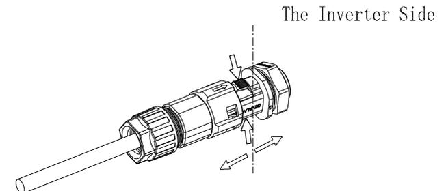
**Paso 2** Inserte la herramienta H y jálela del socket.
