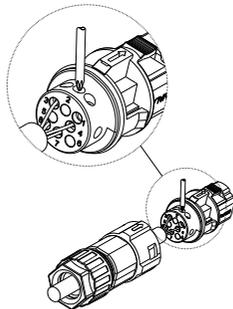
Paso 3 Empuje la conexión roscada a la terminal de la conexión hasta que ambos estén asegurados firmemente en el inversor.
