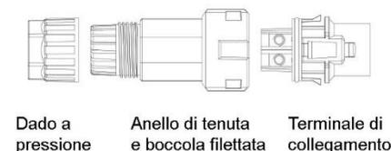
2. Inserire il cavo spelato e scoperto attraverso il dado a pressione, l'anello di tenuta, la boccola filettata in sequenza, inserire i cavi nel terminale di connessione secondo le polarità indicate su di esso e serrare saldamente le viti. Tirare quindi leggermente i conduttori per assicurarsi che siano ben connessi.
